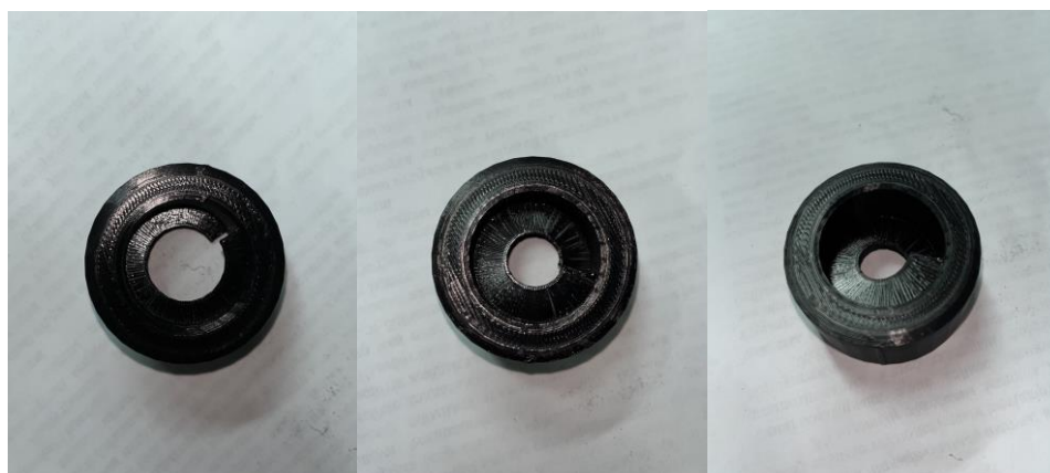
Рисунок 3.10 – Турбулизатор с винтовой пластиной шириной 5, 7,5, 10 мм.
